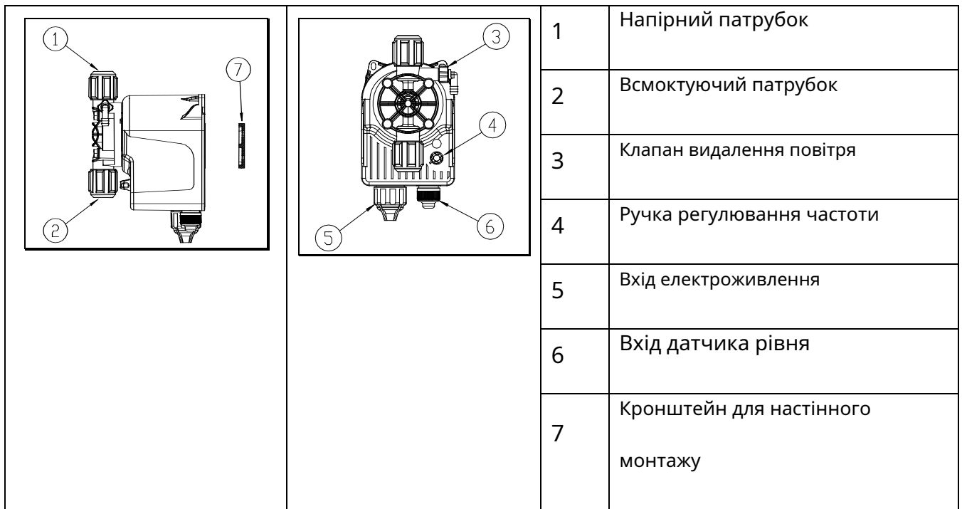
Мал.10. Складові частини насоса
